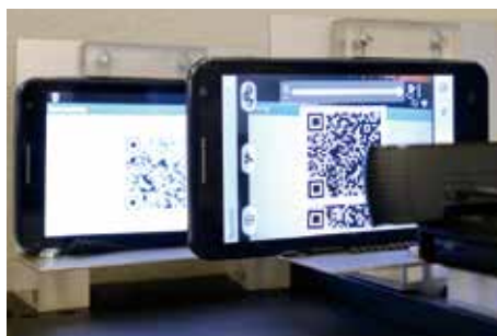
携帯電話を用いたQRコード複製の実験装置。多様な携帯電話に対応した汎用性の高い電子透かしを自動設計できる
